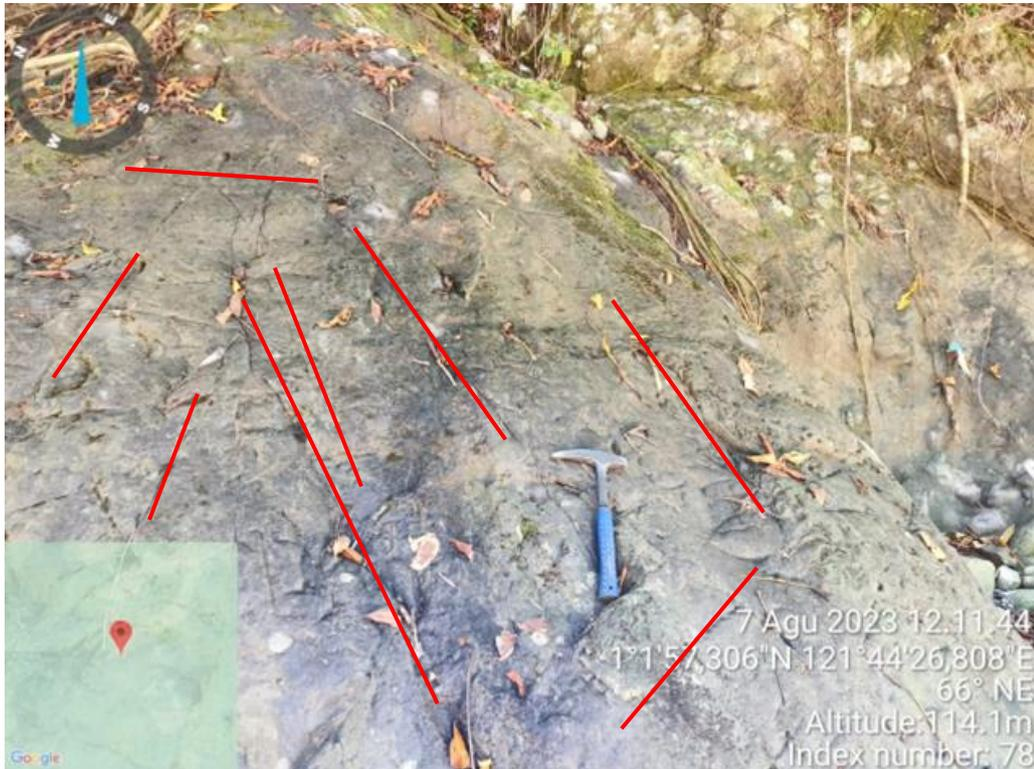
Gambar 4.5 kenampakan struktur geologi berupa kekar non sistematik
